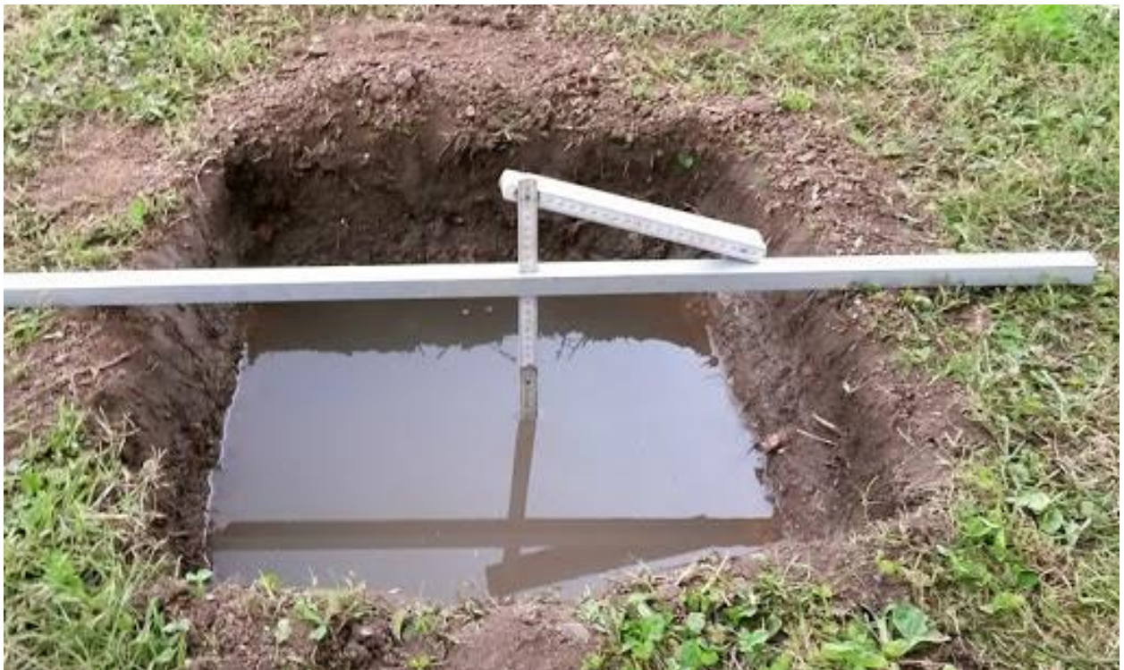
Bild 2: Versickerungsversuch mittels Schürf im Open-End-Verfahren
