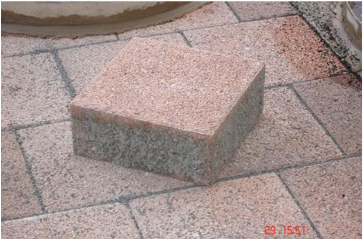
**Abbildung 21: Haufwerksporiger Betonpflasterstein**
