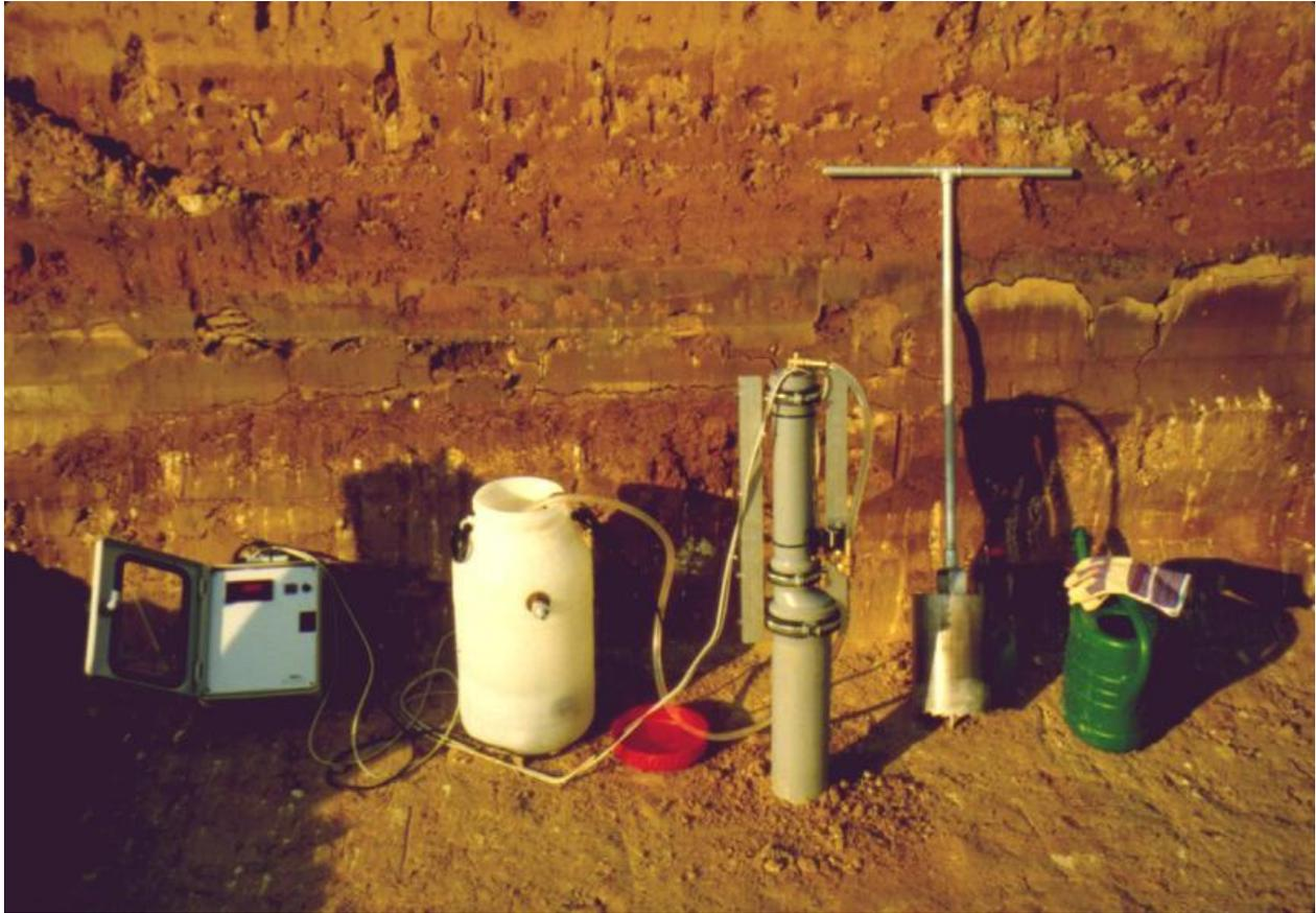
**Abbildung 25: Versuchsaufbau nach dem Open-End-Verfahren**
